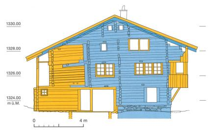
Abb. 8: Adelboden, Hirzbodenportstrasse 10. Ansicht der Südwestfassade. Blau gehalten ist der Kernbau von 1632. In Orange ist die Erweiterung mit sekundärem Bauholz eingezeichnet, welche im Zuge des Stallneubaus im 20. Jahrhundert realisiert wurde. M. 1:150.
