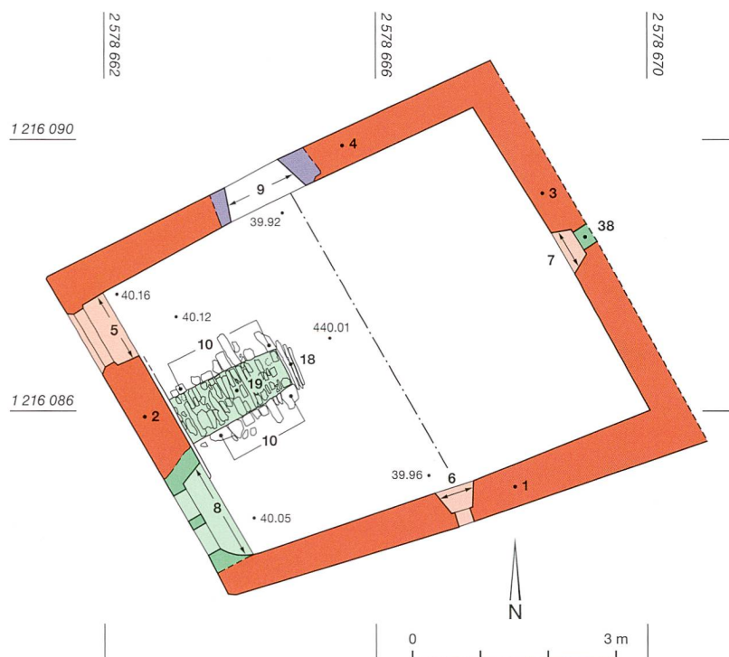
Fig. 2 : Twann-Tüscherz, Dorfгasse 9c. Plan du rez-de-chaussée avec la situation de la fondation du poêle accolée au mur ouest. Seule une moitié de la surface a été explorée. En rouge, la phase ancienne du bâtiment (1485d), en vert la transformation en logement (seconde moitié du 17 e siècle). Éch. 1:100.
