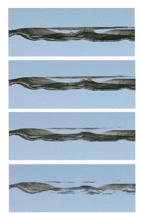
Abb. 21: Sichtbares Verschmelzen zweier Münzoberflächen im Programm 3D Slicer. Mithilfe von Graustufenreglern kann eine optimale Einstellung des zu extrahierenden Münzkörpers gefunden werden. Bei der vierten Filterung sind die Verluste am Münzkörper bereits deutlich sichtbar.
