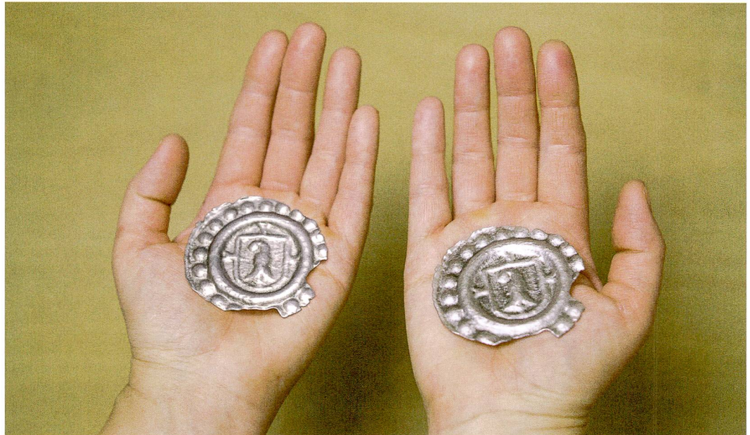
Abb. 23: Aus den vorliegenden 3D-Daten können verschiedenste Produkte erstellt werden. In der linken Hand eine virtuelle Kopie der Münze (Fotomontage), in der rechten eine Kunststoffreproduktion mit dem 3D-Druckverfahren, welche als Replik in einer Ausstellung Verwendung finden könnte.
