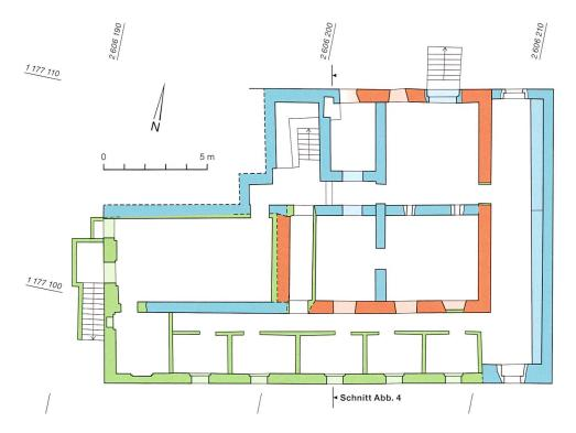
Abb. 2: Blumenstein, Badstrasse 37. Grundriss Kellergeschoss. Der ursprüngliche Kernbau (rot) aus der Zeit um 1600 wurde in den Neubau (blau) von 1879 integriert. Die Baderäume südlich des Kernbaus (grün) entstanden 1932. M. 1:200.
