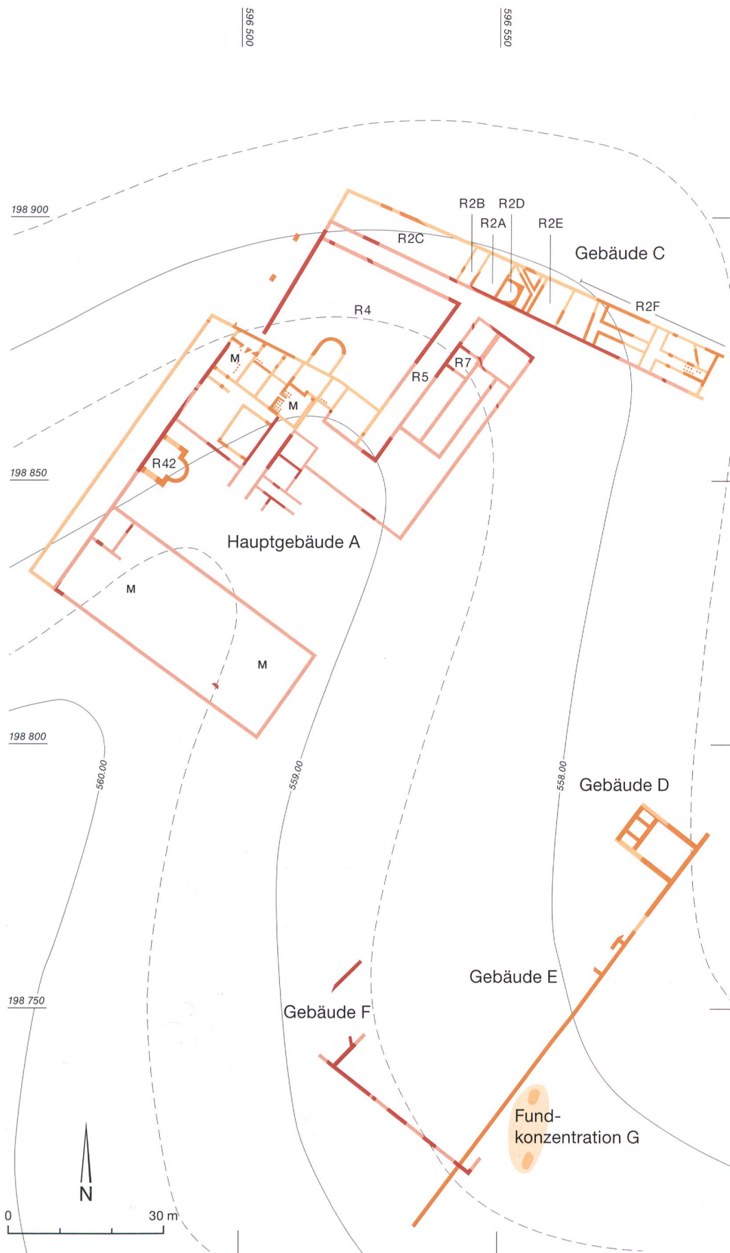
Abb. 6: Bern-Bümpliz. Steinbauphase II, alte Ge- bäude (rot) mit dem Um- bau oder Neubau (orange). Mauerplan mit den belegten Mauern (dunkel) und vermuteten Mauern (hell). Situation um 200 n. Chr. M. 1:1000.
