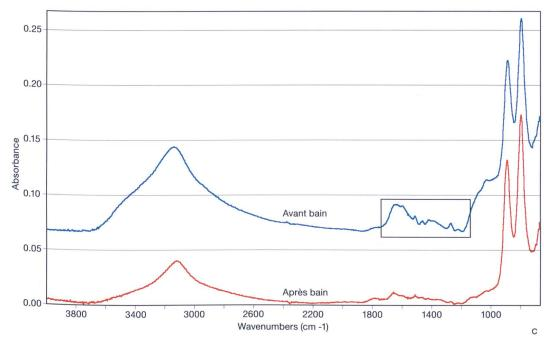
Fig. 6: a Exemple de l'effet d'un bain alcalin (concentrations standards) sur un échantillon de bois minéralisé après un mois. Les parties les moins minéralisées présentent des déformations; b vue des fibres minéralisées sous MEB à pression variable, section radiale: 1000x; c spectre IRTF-µRTA de l'échantillon. On observe la disparition des pics de matière organique résiduelle (rectangle noir), tandis que les pics de la goethite (inorganique) restent inchangés.
