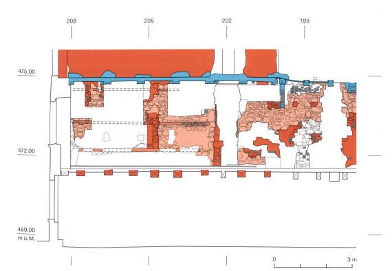
Abb. 5: Wiedlisbach, Städtli 21. Östliche Brandwand zu Parzelle Städtli 19 im ersten Obergeschoss. Deutlich zeichnen sich die Balkenspuren einer gassenseitigen Holzkammer ab, die wahrscheinlich 1423 durch den Stadtbrand zerstört wurde. M. 1:100.
