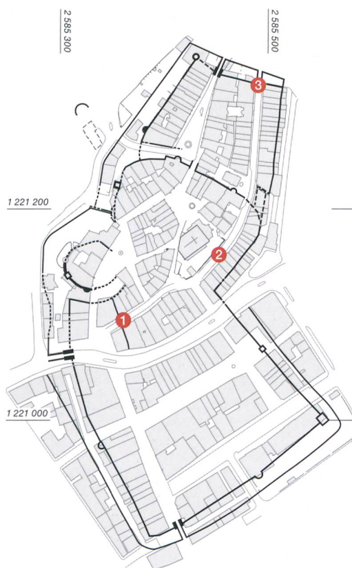
Fig. 1 : Plan de situation des différents vestiges mis au jour: 1 tour de l'Horloge; 2 ancien mur de soutènement de l'esplanade du Temple allemand; 3 porte du Bas. Éch. 1:5000.
