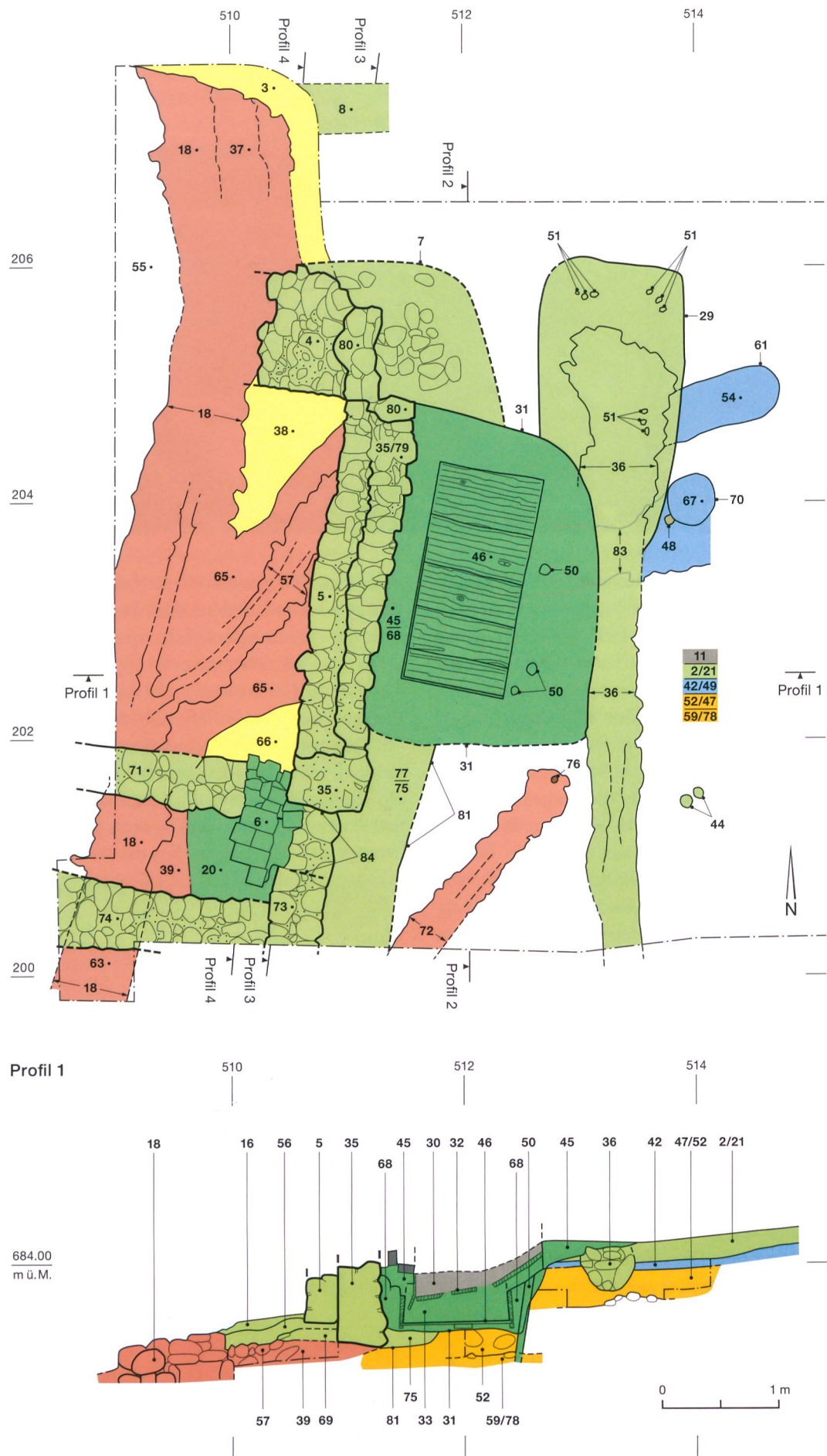
Abb. 5: Langnau, Hinterdorfstrasse 25. Lageplan der Befunde (Ausschnitt) und West-Ost-Profil 1. Schnitt durch die Drainage 18/57/39, die Werkstattfundamente 5/35, die Lehmlagerungsgrube 31/46 und die Drainage 36. M. 1:50.
