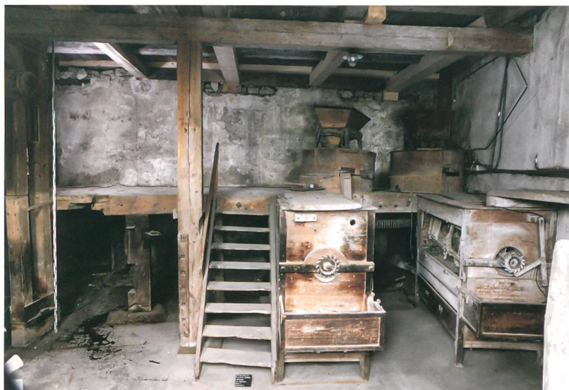
Fig. 3: Plateau de Diesse, Lamboing, Les Moulins 1. Vue intérieure du laboratoire de meunerie avant travaux. Au premier plan, deux blutoirs, à l'arrière-plan, sur le palier, deux meules surmontées de leur trémie respective. Vue vers l'est.
