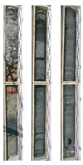
bis in eine Tiefe von 10 m. Die Oberfläche der Bohrkerne wurde gereinigt und zeichnerisch sowie fotografisch dokumentiert (Abb. 1). Die einzelnen Schichten wurden detailliert beschrieben. Aus den archäologisch relevanten Schichtpaketen wurden Proben zur Radiokarbon- und Dendrodatierung entnommen. Einzelne Schichtproben wurden geschlämmt und auf kleinste archäologische sowie botanische Reste untersucht.
