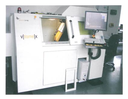
Abb. 15: Stuttgart, Kranstrasse 8. Mikrotomograf der Firma GE phoenix| x-ray.
