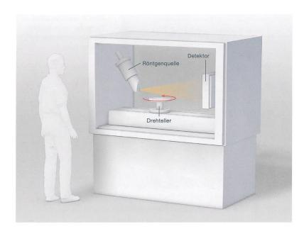
Abb. 9: Schematische Darstellung eines industriellen Tomografen.
