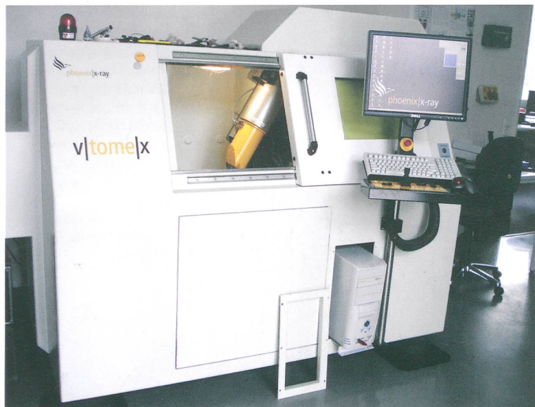
Abb. 15: Stuttgart, Kranstrasse 8. Mikrotomograf der Firma GE phoenix|x-ray.
