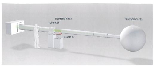
Abb. 19: Schematische Darstellung der Anlage für die Untersuchung mit Neutronenstrahlung.
