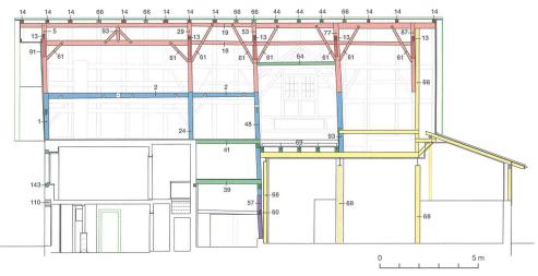
Fig. 2: Saules, Milieu du Village 9. Charpente avec les fermes superposées des 17° et 18° siècles. Vue vers l'est.
