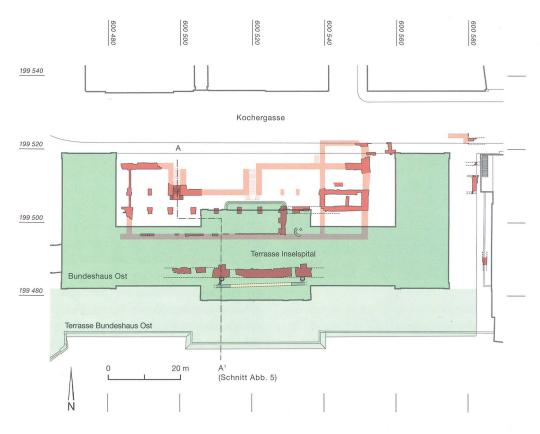
Abb. 2: Bern, Kochergasse 9. Grundrissplan des barocken Inselspitals. Rot: 2013 freigelegte Mauern und Pfeiler des Inselspitals; hellrot: Rekonstruktion des Inselspitals; blau: Entwässerungssystem, Sodbrunnen. M. 1:1000.
