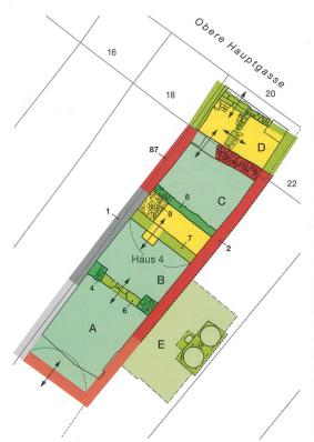
Abb. 20: Thun, Obere Hauptgasse. Rekonstruktion der Hausgrundrisse. Die älteste Brandmauer 1 (grau) gehört zum mittelalterlichen Kernbau (Haus 1). Im Spätmittelalter wurde Haus 4 (rot) angefügt. M. 1:250.
