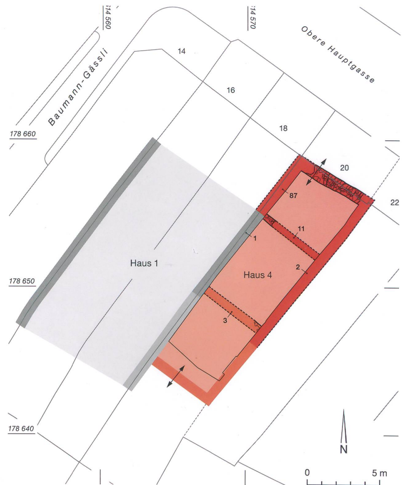
Abb. 20: Thun, Obere Hauptgasse. Rekonstruktion der Hausgründisse. Die älteste Brandmauer 1 (grau) gehört zum mittelalterlichen Kernbau (Haus 1). Im Spätmittelalter wurde Haus 4 (rot) angefügt. M. 1:250.
