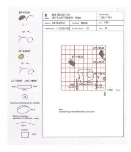
In einem ersten Schritt wurde auf die manuellen Umzeichnungen an Land verzichtet. Die Aufzeichnungen auf der Plexiglasplatte werden nun mit einer Digitalkamera abfotografiert. Die Kamera ist fest installiert und exakt auf das Zentrum der Primärzeichnung ausgerichtet, um einen Verzug möglichst minimal zu halten. Ein Fotobearbeitungsprogramm von Canon erleichtert die Ablage der Digitalaufnahmen zur nachfolgenden Bearbeitung mit den Adobe-Grafikprogrammen Photoshop und Illustrator.
