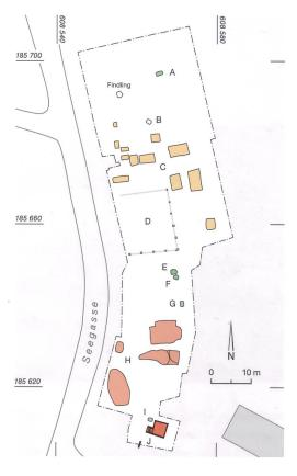
Abb. 3: Kirchdorf, Winkelmatt. Übersicht über die neuzeitliche Gartenanlage. A: Brandgrube; B: kleine Grube mit Staketenlöchern, «Silo»: C: Vorratsgruben; D: Nutzgarten; E: Mörtelsumpfgrube; F und G: kleine Gruben mit Trockenmauern; H: Sandentnahmegruben; I: kleine Grube; J: Keller. M. 1:1000.
