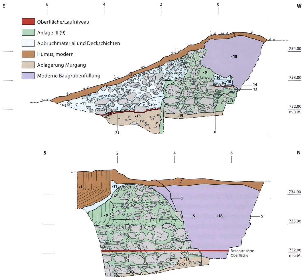
Abb. 8: Wimmi, Spissi. Phase 4, Profil 1 und 3. Die Landmauer (Anlage III) wurde teilweise abgebrochen und die mittelalterliche Oberfläche von Trümmerschutt bedeckt. Eine jüngere Humusschicht gehört zur heutigen Weidefläche.
