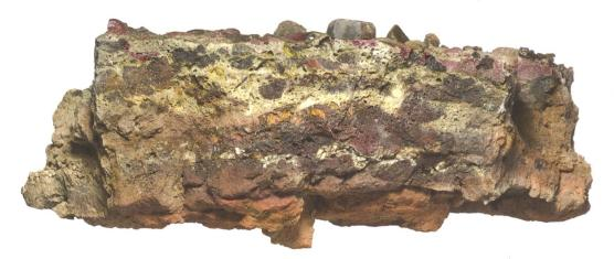
Abb. 10: Langenthal, St. Urbanstrasse 40–44. Ofen 46, Querschnitt durch die Sohle des Feuerungsraumes. M. 1:3.
