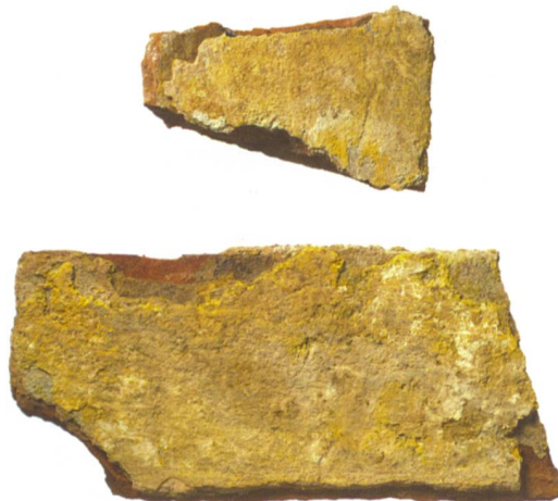
Abb. 22: Langenthal, St. Urbanstrasse 40–44. Sekundärverbaute, stark gebrannte Dachziegel mit Spuren einer gelben «Blei-Zinn-Asche» aus der Arbeitsgrubenwand 67 von Ofen 47. M. 1:3.
