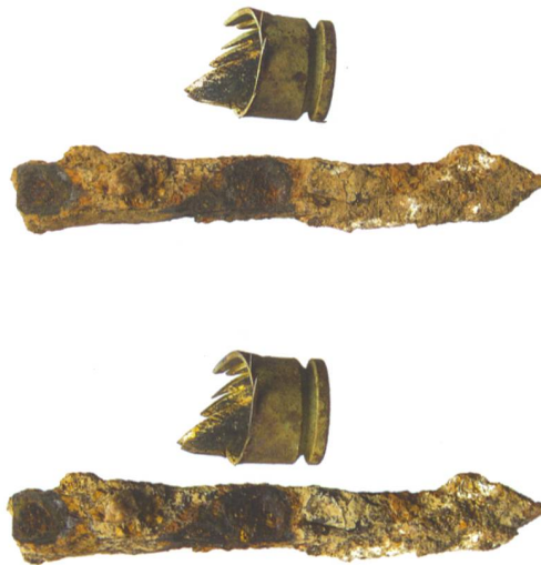
Abb. 2: Probekörper nach der Behandlung. Es treten keine Korrosionserscheinungen auf. M. 1:1.
