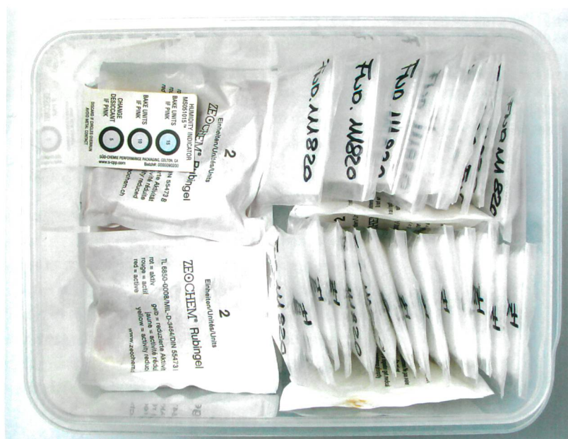
Fig. 3: Emballage d'objets ferreux suivant la méthode de conservation passive.
