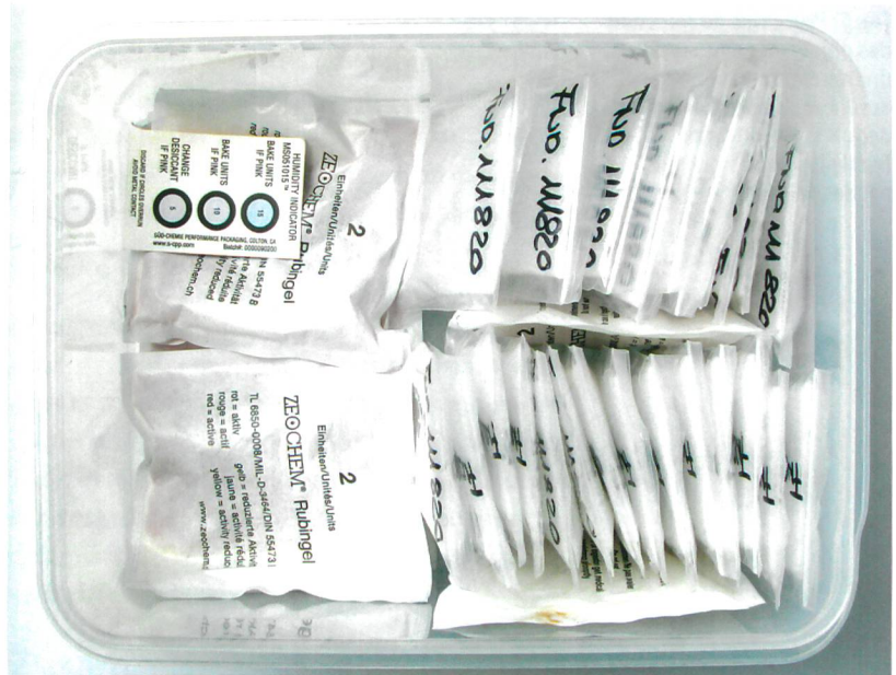
Fig. 3: Emballage d'objets ferreux suivant la méthode de conservation passive.
