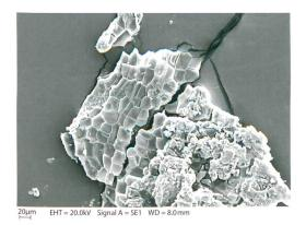
Abb. 5: Spiez-Einigen, Holleeweg. Blechfingerring (Fnr. 105984). Struktur mit netzartiger Oberfläche. REM-Foto.
