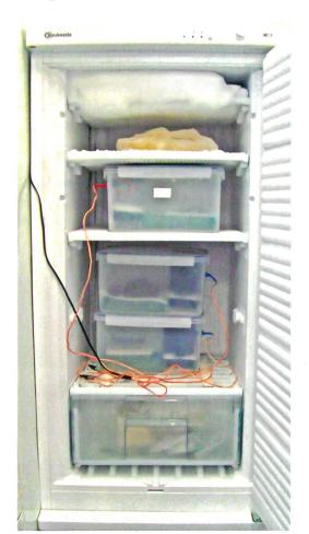
Fig. 2 : L'AFDbox, placée dans un congélateur, doit être sortie pour la pesée des objets en cours de séchage et le renouvellement du gel de silice.
