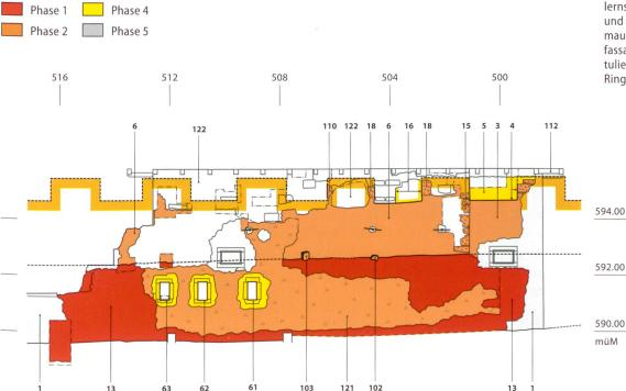
Abb. 3: Köniz, Schloss, Muhlernstrasse 15. Umzeichnung und Phasenplan der Nordmauer des Rossstalls, Südfassade. Phase 2 mit postuliertem Torturm in der Ringmauer. M. 1:150.
