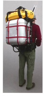
Fig. 2: Prototype de caisson isotherme et équipement fixés sur un Tatonka® Lasten-kraxe.
