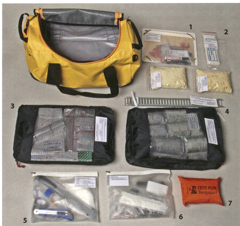
Fig. 1 : Equipement de conservation in situ préparé en vue d'une prochaine expédition. 1 Matériel de documentation. 2 Protection (masques et gants). 3 Divers outils. 4 et 5 Matériel d'emballage et de protection. 6 Eléments de fixation. 7 Trousse de premiers secours.
