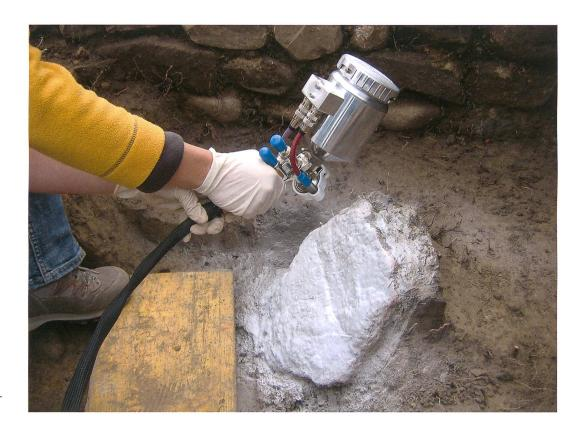
Abb. 1: Anwendung der CDAN-Schmelze mit der Sprühpistole auf Fragmente römischen Terrazzoverputzes in Jegenstorf, Solothurnstrasse.
