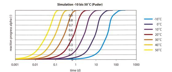
Abb. 2: Logarithmische Darstellung des simulierten Reaktionsverlaufes der Sublimation von CDAN-Puder bei isothermen Temperaturen von –10, 0, 10, 20, 30, 40 und 50°C (Messung: Mettler Toledo TGA/SCTA 851e und STARe Software 8.10. Auswertung: AKTS-Thermokinetics-Software 2.56).
