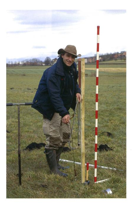
Abb. 1: Seedorf, Lobsigesee. Roland Haab beim Setzen einer Piezometer-Sonde zur permanenten Messung des Grundwasserstandes.
