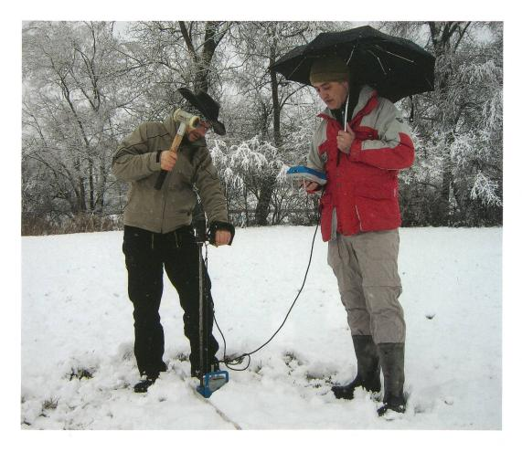
Abb. 2: Seedorf, Lobsigesee, Luzius Matile und Marco Achermann führen im Rahmen von bodenkundlichen Untersuchungen Messungen mit einem dynamischen Penetrometer (PANDA-Sonde) aus. Anhand der gemessenen Eindringwiderstände können dichtere (mineralische/antorfige) und lockere Schichten (Torf) im Bodenprofil lokalisiert und in Zusammenhang mit dem Abbauzustand am untersuchten Standort gebracht werden.
