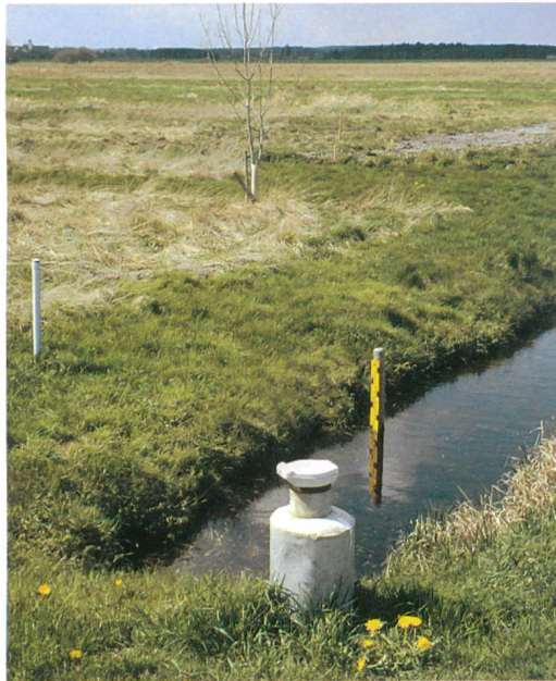
Abb. 12: Pegelmessstationen kontrollieren den Grundwasserstand in einem wiedervernässten Bereich des Federsee Moores. Die archäologische Substanz bleibt unter der Torfdecke erhalten.
