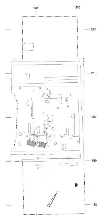
Abb. 115: Ostermundigen - Dennikofe 2002/03. Fläche 1/2. Prähistorische Feuerstelle (schwarz), Werkgruben (grau) sowie römische Holz- und Steinbauten (linear). M. 1:250.
