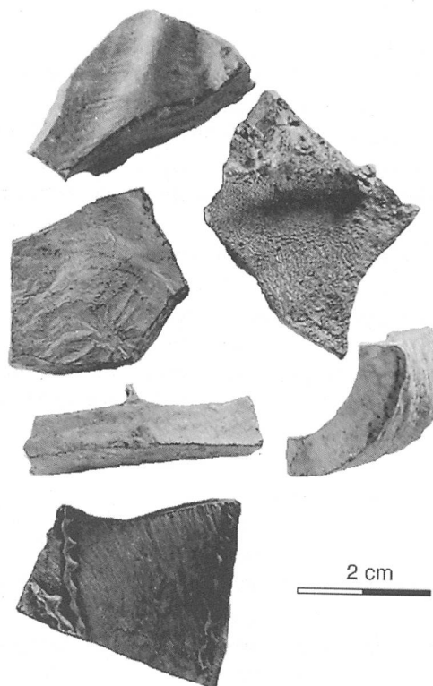
Abb. 2: Makroskopische Abbildungen von Fließschlacken.
