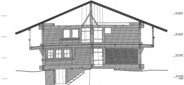
Abb. 15: Aufriss Ostfassade, Wandebene. M. 1:100. Legende s. Abb. 3.
