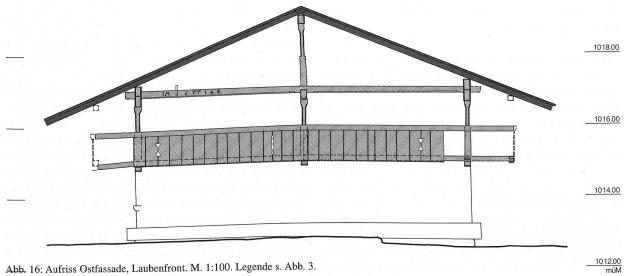
Abb. 16: Aufriss Ostfassade, Laubenfront. M. 1:100. Legende s. Abb. 3.
