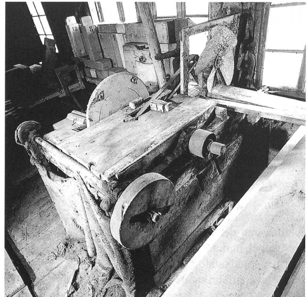
Abb. 4: Die verlassene Drehbank für Röhrenmuffen, Zustand vor unseren Grabungen 1988.
