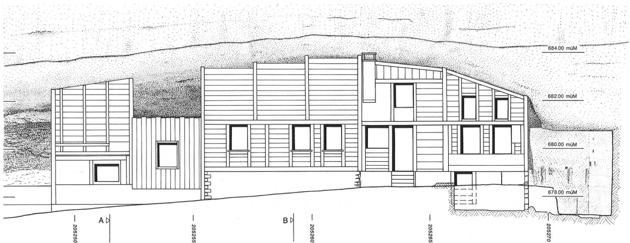
Abb. 249: Krauchthal, Äusseres Fluhhäuschen. Vereinfachter Aufriss der Fassade. M. 1:150.
