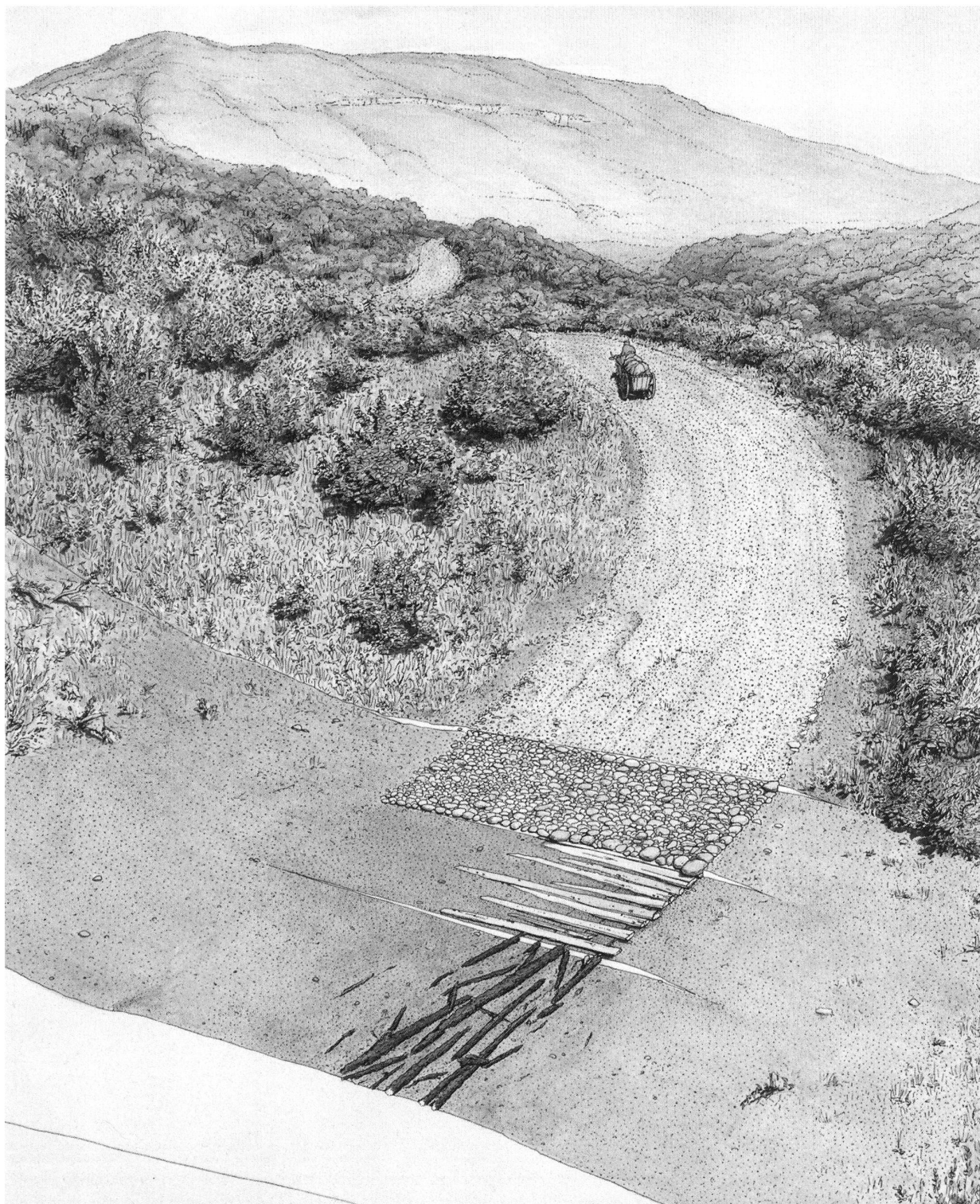
Fig. 126: Tavannes - Tavapan I. Essai de reconstitution de la route romaine. Sous le niveau de circulation graveleux se trouve le radier de blocs calcaires. Dans la moitié aval, nous avons observé une sous-construction en bois.
