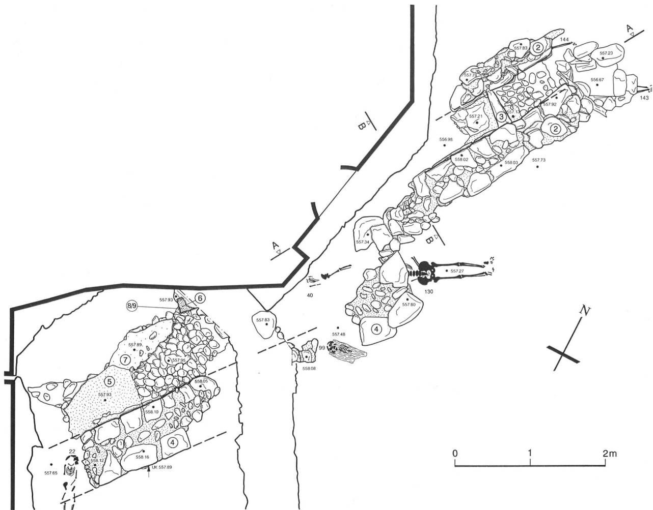
Abb. 6: Ausschnitt der Befunde zu Grabkammer und Westanbau. Grundriss M.1:50. 2 Seitenmauern, 3 gestellte Platte (Zwischenwand), 4 Schulter und Südmauer Westanbau (Memoria?), 5 Mörtelgussboden auf Kieselrollierung, 6 Schrankenpfostennegativ (?), 7 grosse Flickstelle in Mörtelguss, 8 kleine Flickstelle zu (6), 9 Flickmörtel.
