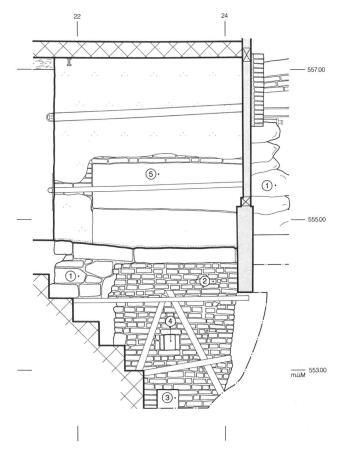
Abb. 6: Ansicht des Brennofens C von Osten. M. 1:50. 1 älterer Kieselund Bruchsteinmantel, 2 jüngerer Backsteinmantel, 3 Aschegang, 4 Einfeuerungsöffnung, 5 Brenngutraum.
