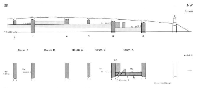
Abb. 4: Bern-Bümpliz - Mauritiuskirche 1898. Situation nach Abriss der Kirchhofmauer. Profil auf der Grundlage der publizierten Zeichnung von 1898, korrigiert mit den Massen der Feldaufnahmen 1898 und Erkenntnissen der Grabung 1968. M. 1:200.
