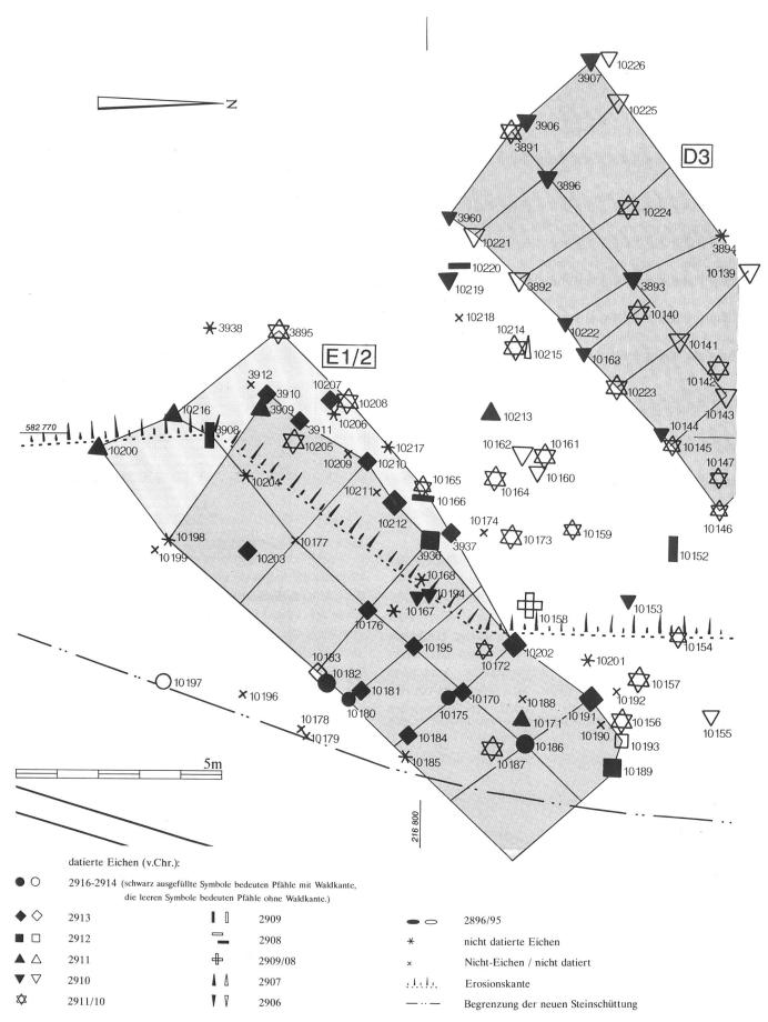
Abb. 13: Sutz-Lattrigen - Sutz Südwest Va 1988/89 und 1993. Grundrisse der Häuser E1/E2 und D3. Die Pfähle des Hauses E1 sind mehrheitlich 2913 v.Chr. gefällt worden. 2911/10 v.Chr. findet seeseitig ein Anbau statt. Das Gebäude D3 ist wahrscheinlich im Frühling 2910 v.Chr. errichtet worden. Möglicherweise erstreckte sich der postulierte Prügelboden zwischen den Häusern E1/E2 und D2/D3 über die ganze dazwischenliegende Fläche. Letzte Ausbesserungen fanden 2909/08 v.Chr. statt. M. 1:100.
