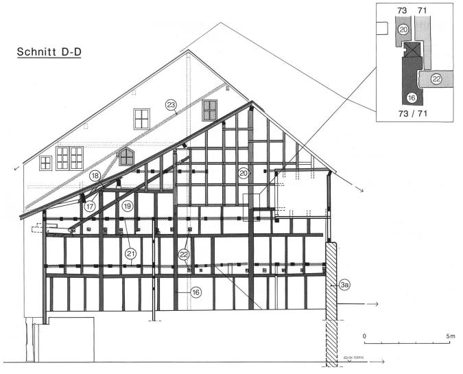
Abb.14: Bälliz 73. Mittlere Brandmauer nach Westen. M. 1:150. Signaturen s. Abb. 2. 2b Mauerrest, 16 Ständerkonstruktion Bälliz 71/Erweiterungsetappe II, 17 Gefaster Balkenkopf, 18 Dachsparren Bälliz 71, 19 Langstrebe, 20 Ständerwerk Bälliz 73/Erweiterungsetappe IV, 21 Balkenlagen zu Bälliz 73/Erweiterungsetappe IV, 22 Balkenköpfe von Bälliz 71/Erweiterungsetappe III, 23 Dachlinie Bälliz 71/Erweiterungsetappe III.
