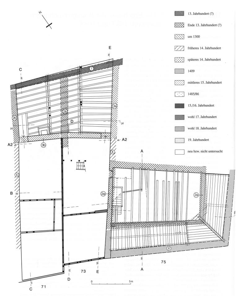
Abb. 2: Bälliz 71–75. Grundriss des 1. Obergeschosses mit Bauperiodisierung. Massstab 1:150. 1 Grabenmauer, 2a Kernbau Bälliz 75, 2b Kernbau Bälliz 71, 3a Kernbau Bälliz 73, 3b Kernbau Bälliz 71 und 73, 4 Hofmauern (spätere Brandmauern), 6 Erneuerung Bälliz 75 (1409).
