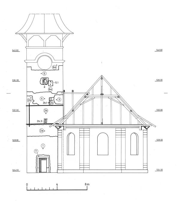
Abb.5: Ansicht an die Ostfassade des Turmes mit Querschnitt durch den Kirchendachstuhl. M. 1:150.
