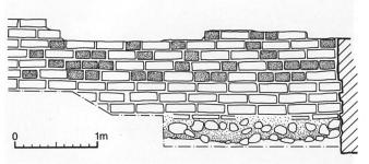
Abb.16: Mauertechnik der Backsteinmauer. Dunkel gepunktet die Binderlagen, weiss die Läufer. M. 1:50.
