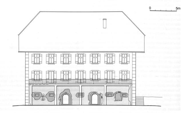
Abb.120: Saanen, Pfarrhaus. Baugeschichtliche Aufschlüsse am Sockelgeschoss der Südfassade. M. 1:200. Mittelalterliche Substanz (heller Raster) und Veränderungen des 18. Jahrhunderts (dunkel) im Bereich des Erdgeschosses.
