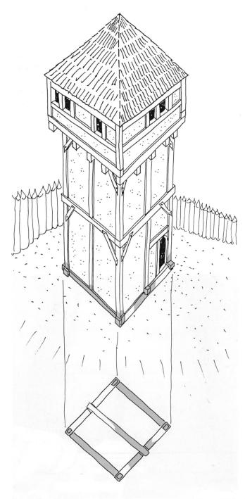
Abb.115: Nidau, Schloss. Rekonstruktion des Holzturmes von Nidau aufgrund der erhaltenen Hölzer (gerastert). Er stand auf einem künstlich aufgeworfenen Hügelchen.
