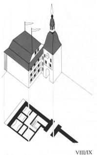
Abb.129: Wangen a.d.Aare, Gemeindehaus. Isometrische Entwicklung der Bausubstanz seit dem 13. Jahrhundert. Phasen I–IX (s. Text).
