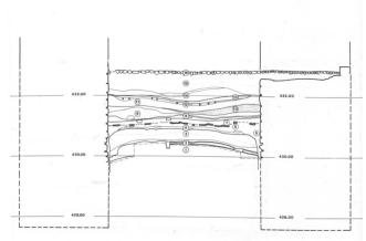
Abb.116: Nidau, Schloss. Querschnitt durch die Fundamente des Bergfrieds und die dort abgelagerten Schichten.
