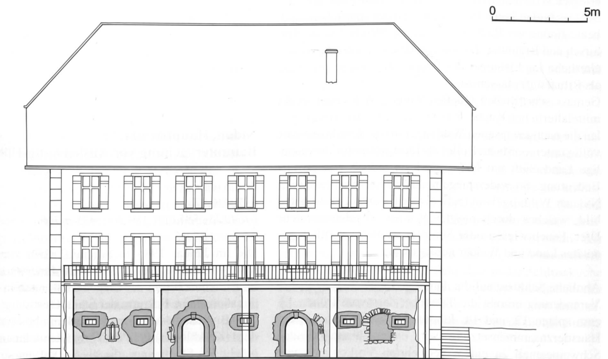
Abb.120: Saanen, Pfarrhaus. Baugeschichtliche Aufschlüsse am Sockelgeschoss der Südfassade. M. 1:200. Mittelalterliche Substanz (heller Raster) und Veränderungen des 18. Jahrhunderts (dunkel) im Bereich des Erdgeschosses.
