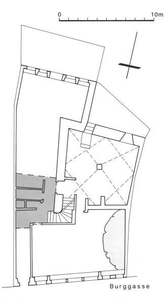
Abb. 82: Biel, Burggasse 17. Situationsplan, M. 1:200. Dunkler Raster: Grabungsfläche für Liftschacht, heller Raster: Rundturm der Burg.
