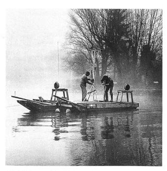
Abb. 6: Bielerseeprojekt 1984–87. Ipsach. Kernbohrung ab schwimmender Plattform.
