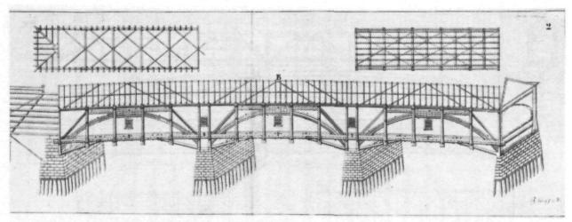
Projekt 1 für mehrteilige Aarebrücke mit zwei überlagerten Tragkonstruktionen, 1804 (Aarau – Stadtbauamt)
