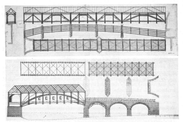
Zwei der 1806 von Grubenmann zum Eglisauer Brückenvorhaben eingereichten Vorschläge. Oben: Jochbrücke mit einfachen und doppelten Hängewerken. Unten: kombinierte Stein/-Holzkonstruktion (StAZH, Pläne M5, M21)
