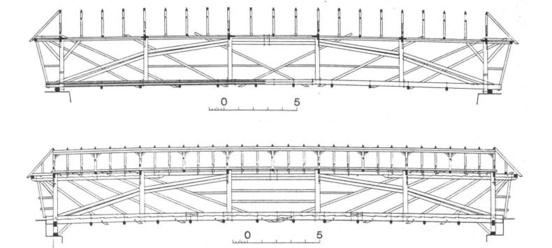
Abb. 9 (ganz oben). Hundwil. Urnäschbrücke im Herisauer Tobel bzw. Hundwiler Tobel, 1778, von Hans Ulrich Grubenmann. Längsschnitt.
