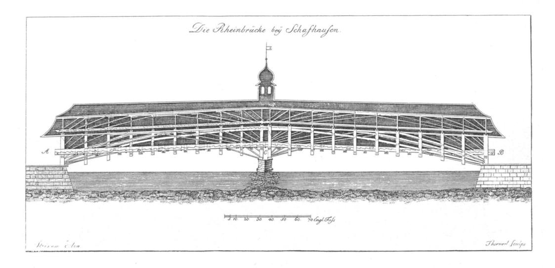
Abb. 14. Schaffhausen. Rheinbrücke, 1755—1758, von Hans Ulrich Grubenmann. Längsschnitt des ausgeführten Projekts, Radierung, um 1798, von Thoenert nach Zeichnung von Steinem.
