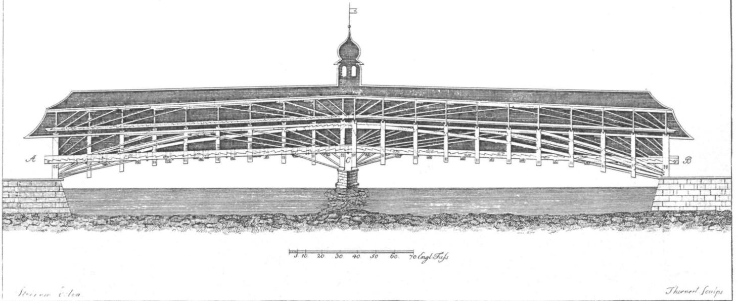
Abb. 14. Schaffhausen. Rheinbrücke, 1755—1758, von Hans Ulrich Grubenmann. Längsschnitt des ausgeführten Projekts, Radierung, um 1798, von Thoenert nach Zeichnung von Steinem.
