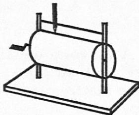
Voici un rouleau sur lequel on a fixé une feuille de papier qui le recouvre exactement; ce rouleau peut tourner autour de son axe à l'aide de sa manivelle. Un crayon dont la pointe appuie sur le papier peut être déplacé le long de la tige de métal.
