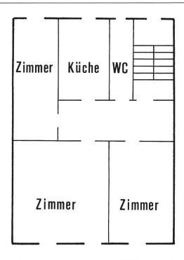
Abb. 99. Schematischer Grundriss einer Dreizimmerwohnung.
