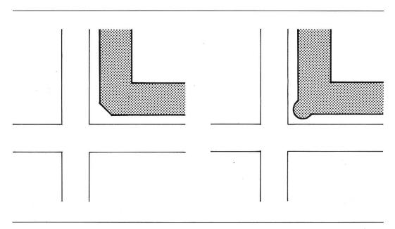
Abb. 97 (links). Schematischer Grundriss einer Reihe mit abgeschrägter Ecke. Abb. 98 (rechts). Schematischer Grundriss einer Reihe mit einem Eckturm.
