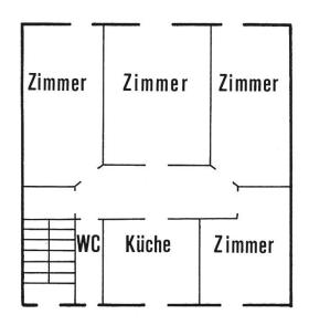
Abb. 100. Schematischer Grundriss einer Wohnung mit schrägen Zimmereingängen.
