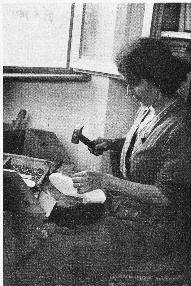
Auf den Volkszoccoli werden die bereits geschnittenen Lederriemen aufgesetzt.
