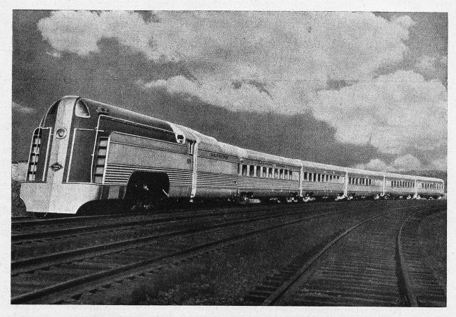
Sesamt-Ansicht des neuen Stromlinien-Zuges aus rostfreiem Stahl, der täglich zweimal zwischen New-Nork und Philadelphia hin- und zurückfährt (ohne einen Cent Zuschlag). Der ganze Zug in Silber und Blau bildet eine geschlossene Sinheit; er besteht aus der Lokomotive, zwei Aussichtswagen, zwei Salonwagen und einem Speisewagen. Innen ist jeder Wagen anders, aber jeder streng modern und sehr geschmackvoll eingerichtet.
